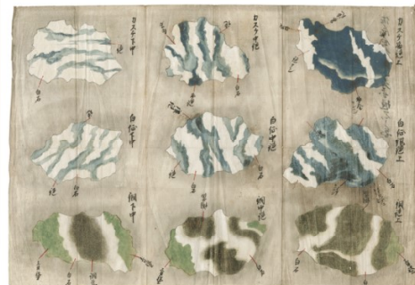
Dessin décrivant la méthode de classification de la qualité des minerais (« Kinginzan Taigaisho » : manuel technique des mines d'or et d'argent, 18 e siècle)
