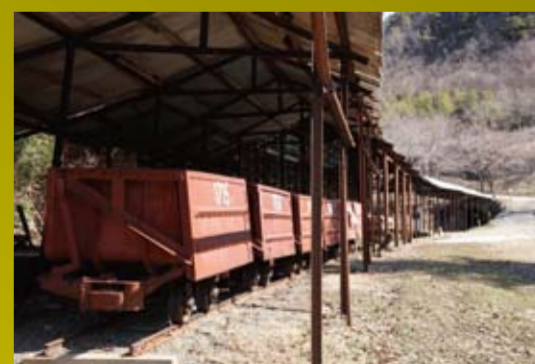
鉱山で使用された鉱石運搬用のグランビー鉱車 昭和30年代よりこの鉱車が使われ始め、道遊坑では20輛前後の鉱車を連結し鉱石を破砕場まで運んでいた。
